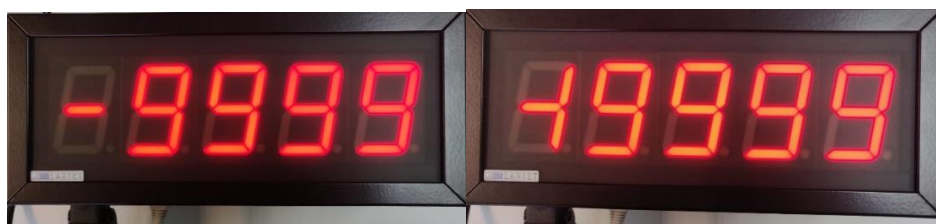
Fig. 14: A la izquierda, valor mínimo en “FULL DIGIT”, -9999. A la derecha, valor mínimo en “HALF DIGIT”, -19999.
