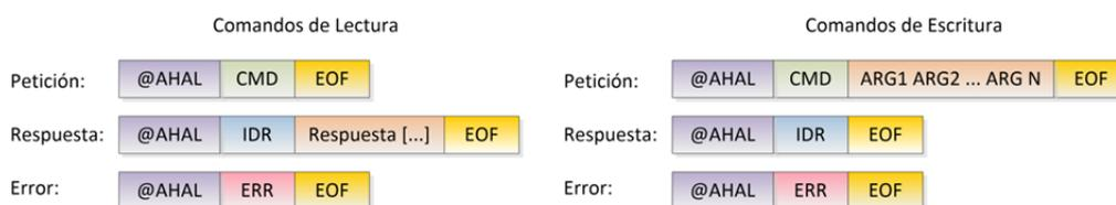
Fig. 4.10 Estructura de comandos para las interfaces Serie
