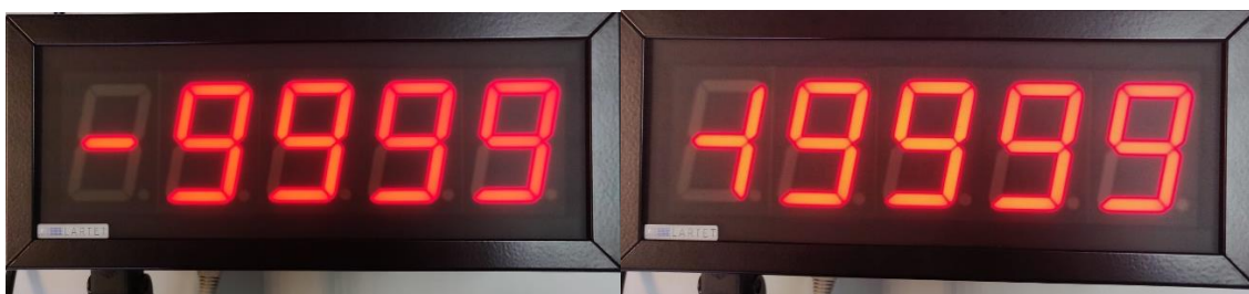
Fig. 17: A la izquierda, valor mínimo en "FULL DIGIT", -9999. A la derecha, valor mínimo en "HALF DIGIT", -19999.
