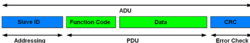
Fig. 30: Diferencias de Modbus/TCP y Modbus/RTU.
